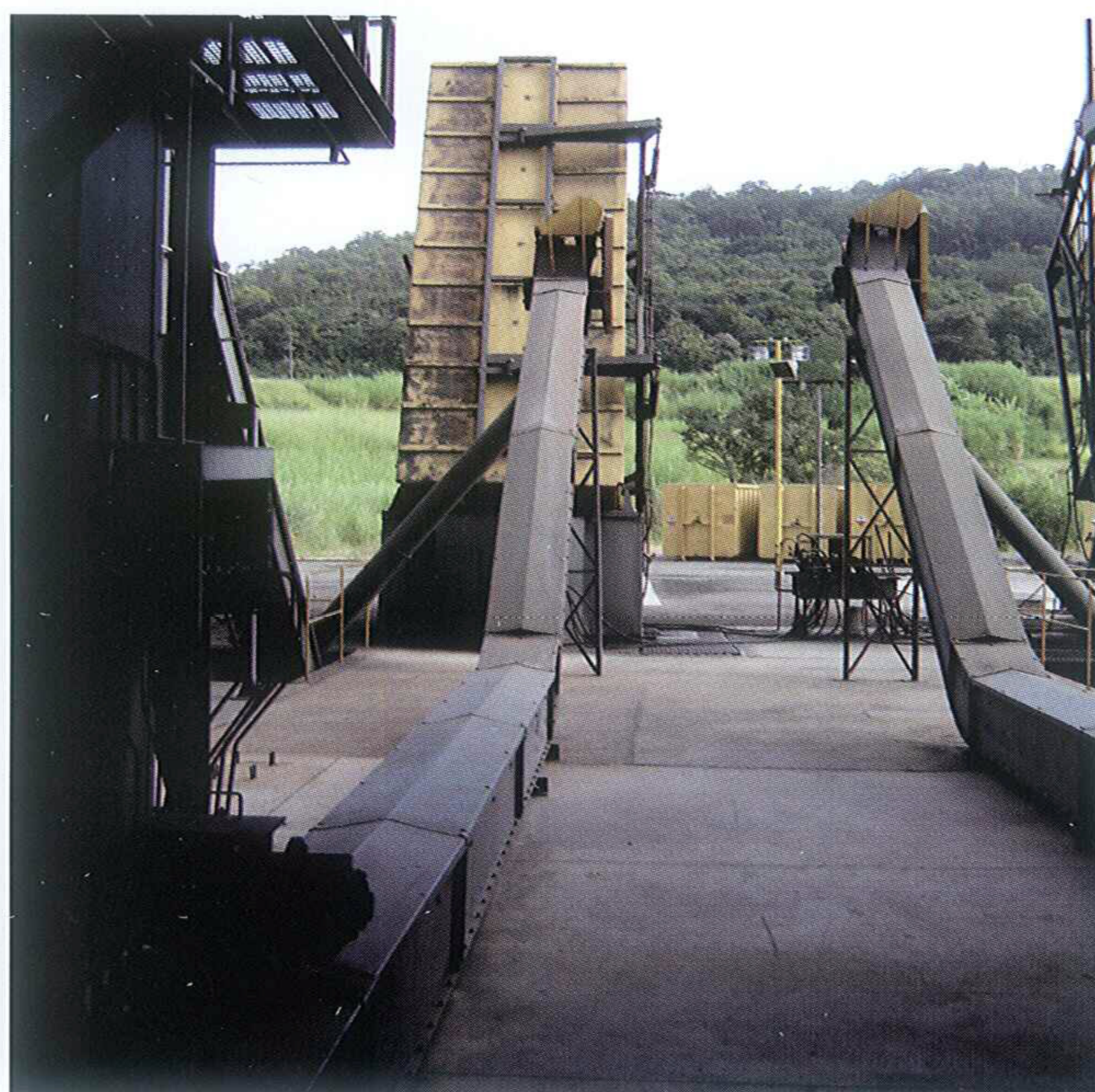
Transportador de corrente com curva para extração de cinzas e resíduos secos.
