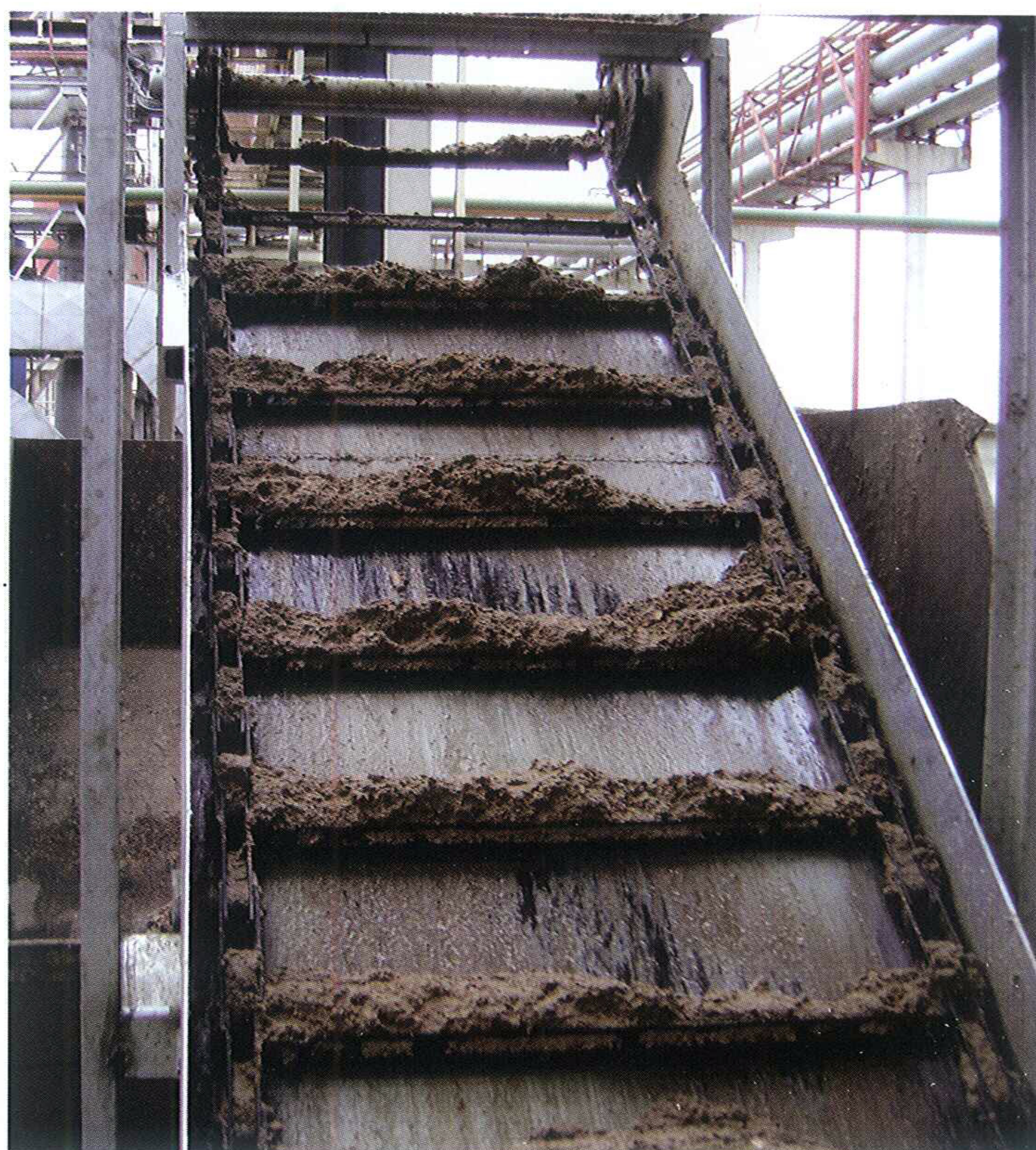
Transportador com corrente dupla com taliscas retirando resíduos de biomassa em processo de decantação em tanque.
