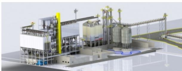
**São Gabriel do Oeste / MS** - 90 t/h para suínos; silos exclusivos para diferentes qualidades do mesmo cereal; transilagem nos silos de farelos para evitar compactação do produto; estruturas tubulares e pisos totalmente aparafusados, moinhos fabricados com matérias primas de alta resistência sem similaridade no mercado; expedição preparada
